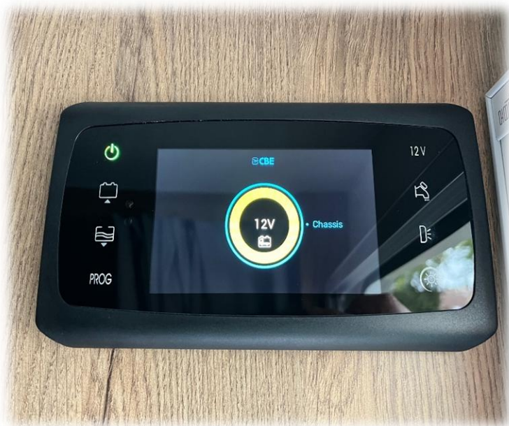
Ilustracja nr 3- Panel sterownika CBE oraz włączniki ogrzewania (sposób rozmieszczenia może się nieznacznie różnić w zależności od wersji wyposażenia wnętrza)
