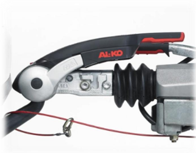
Ilustracja nr 2- sposób zaczepienia linki awaryjnej -hak demontowany.
