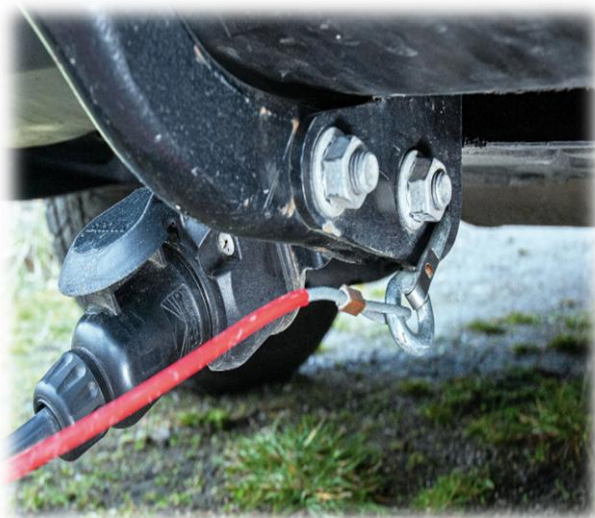
Ilustracja nr 1-sposób zaczepienia linki awaryjnej - hak stały
