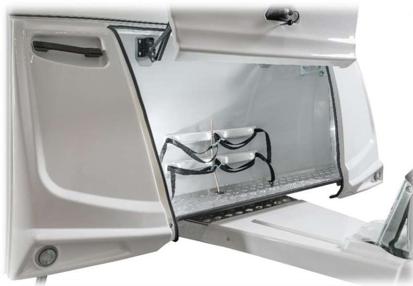
Ilustracja nr 5-miejsce do zamontowania i przewozu butli gazowej
