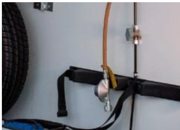
Ilustracja-przewód gazowy z reduktorem
