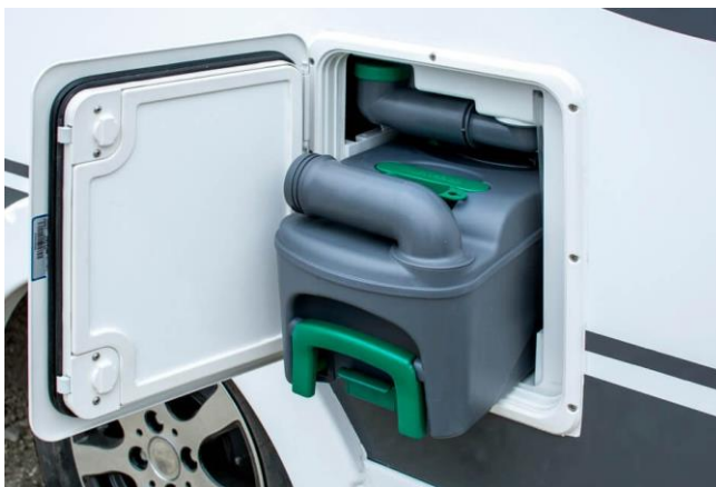
Ilustracja nr 6- wysunięta kasea toaletowa widoczna poprzez otwarte drzwiczki dostępu
