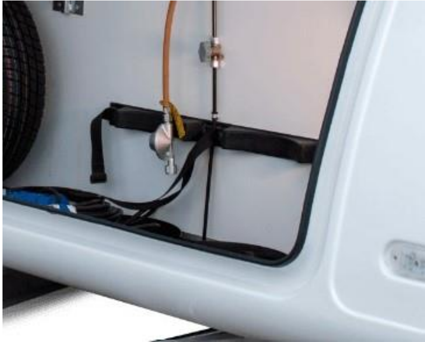
Ilustracja nr 5- miejsce na butlę gazową wraz z pasami mocującymi, wężem elastycznym i reduktorem
