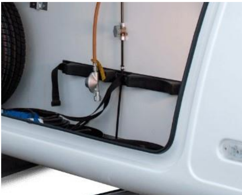
Ilustracja nr 5- miejsce na butlę gazową wraz z pasami mocującymi, węzłem elastycznym i reduktorem
