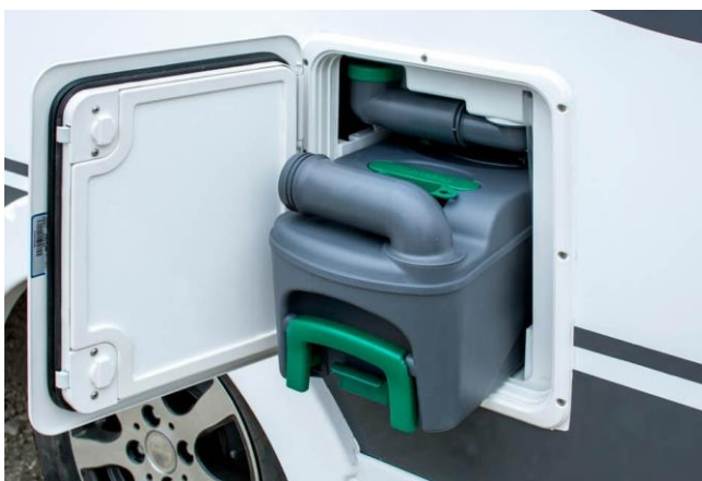
Ilustracja nr 6- wysunięta kaseeta toaletowa widoczna poprzez otwarte drzwiczki dostępu
