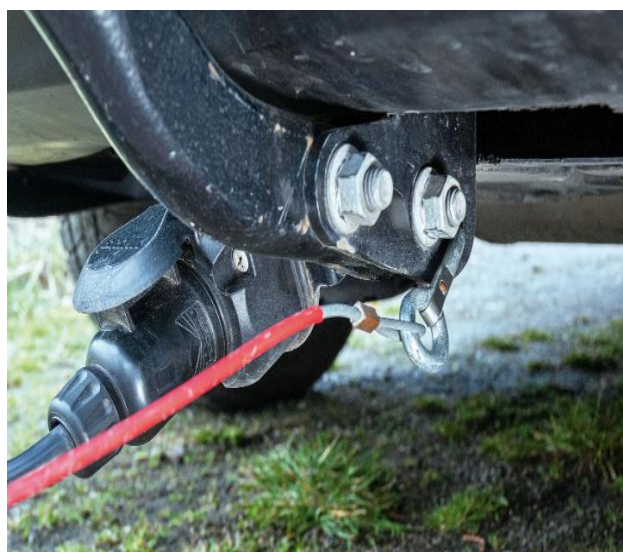
Ilustracja nr 2- sposób zaczepienia linki awaryjnej - hak demontowany
