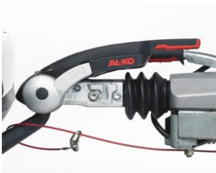
Ilustracja nr 2- sposób zaczepienia linki awaryjnej-hak demontowany
