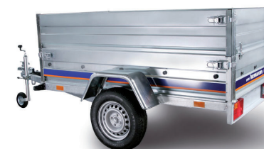
BD7520UN – przyczepa z dodatkowymi nadstawkami burtowymi może być wykorzystana do przewożenia ładunków o większych gabarytach
